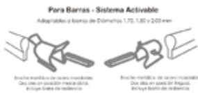
Sistema de Conexión Horizontal Compensa tensiones del metal
