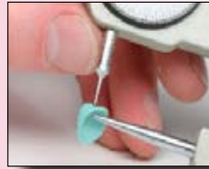
Chequeo de espesores con calibre (mínimo 0,5 mm-máximo 0,7mm).
