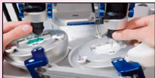
Inserción de las fresas de inspección y fresado.
